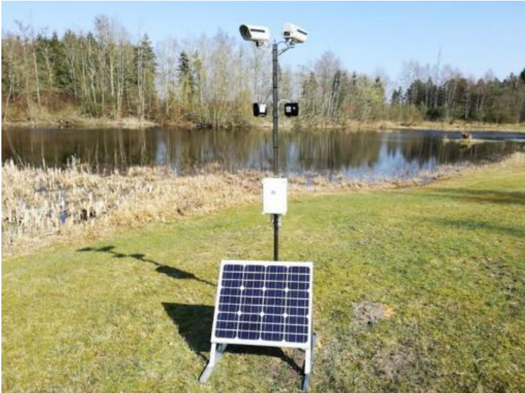
Billede 2. Sensorteknik som detekterer dyr, og udløser skræmmelyde. Apparatet her er med solcelle og fra firmaet Anico.
